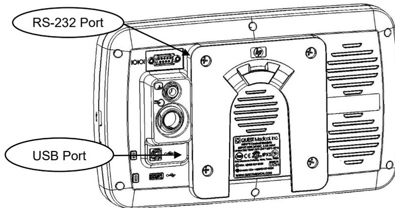
Figure 34: EDMS Ports on MPS 3 Controller
