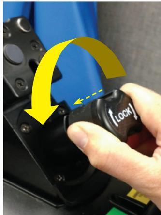
1. Presione la perilla y gírela 360 grados en sentido contrario al de las manecillas del reloj hasta que deje de girar. (La perilla de bloqueo se extenderá hacia afuera)
