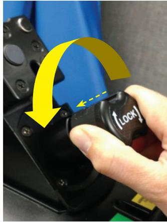
1. Spingere la manopola verso il basso e ruotarla in senso antiorario di 360 gradi finché smette di ruotare. (La manopola di bloccaggio si estenderà verso l'esterno)
