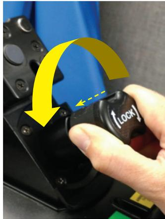
1. Enfoncer le bouton et le faire tourner dans le sens inverse des aiguilles d'une montre à 360 degrés jusqu'à ce qu'il s'arrête de tourner. (Le bouton de verrouillage se prolongera vers l'extérieur)
