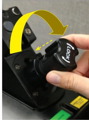
1. En enfonceant le bouton, le faire tourner à 360 degrés dans le sens des aiguilles d'une montre jusqu'à ce qu'il s'enclenche.
