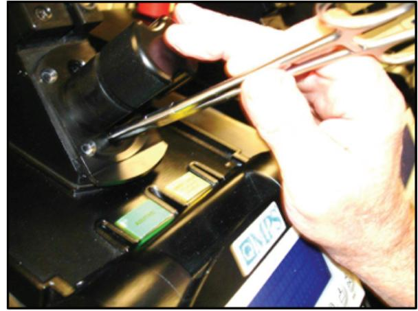
6. Die Verriegelungsblockeinheit eindrücken, während beide Stopfen ausgerichtet bleiben. Die Verriegelungsblockeinheit sollte bündig mit der Unterseite des Wärmetauscherblocks abschließen. Die Stopfen sollten mit den Stopfendichtungen abschließen.
