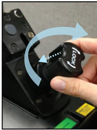
1. Den Knopf nach unten drücken, den Knopf 360 Grad im Uhrzeigersinn drehen, bis er einrastet.
