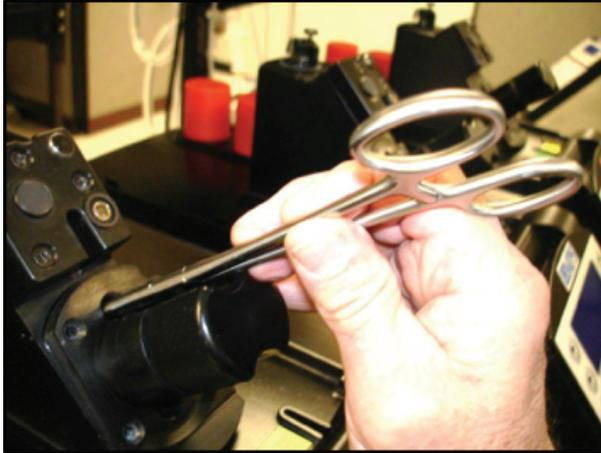
5. Die neue Verriegelungsblockeinheit über die Stopfen platzieren. Die Stopfen mit den im HEX-Block bereitgestellten Bohrungen ausrichten und dabei eine Gefäßklemme zum Zusammendrücken der Federn verwenden.
