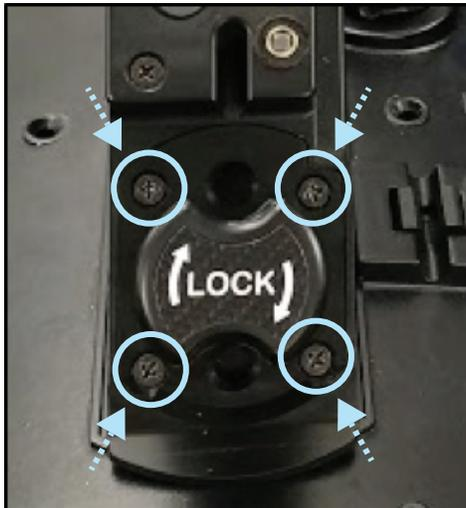
7. Die Verriegelungsblockeinheit halten und die vier Schrauben ersetzen. Jede Schraube fest anziehen.
