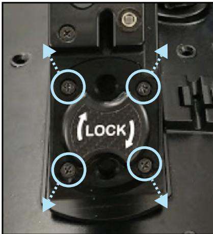
2. Die vier Schrauben entfernen, die die Verriegelungsblockeinheit am HEX-Block sichern. Die Verriegelungsblockeinheit entfernen.
