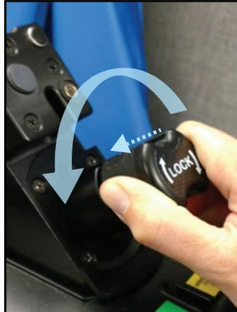
1. Den Knopf nach unten drücken und gegen den Uhrzeigersinn um 360 Grad bis zum Anschlag drehen. (Der Verriegelungsknopf wird abstehen)
